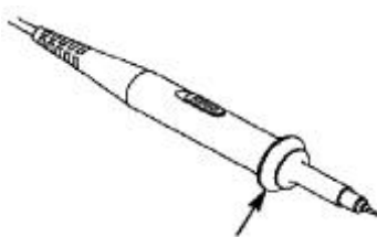
Figure 3-5 : Anneau de sécurité pour le doigt de la sonde
