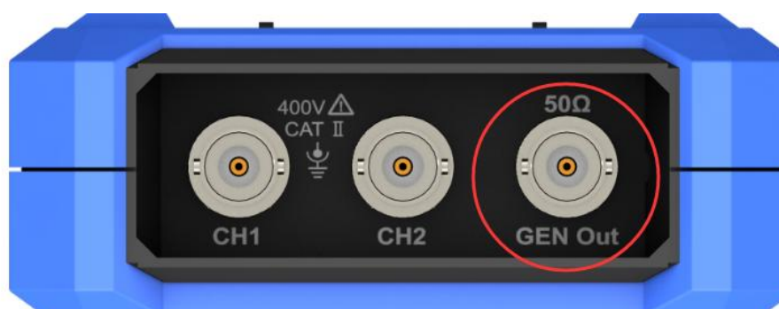
Figure 5-1 : Sortie du générateur de signal
