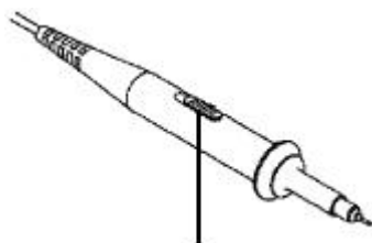
Figure 3-4 :Commutateur d'atténuation de la sonde
