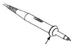
Figura 3-5: Anello di sicurezza per le dita sulla sonda
